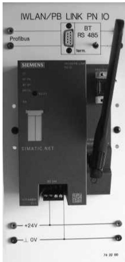
Der in die Experimentierplatte „**IWLAN/PB LINK PN IO**“ eingebaute Netzübergang zwischen Industrial Wireless LAN und Profibus ermöglicht die Anbindung von Profibus DP – Slaves an einen PROFINET IO-Controller. Aus Sicht des IO-Controllers werden alle DP Slaves behandelt wie IO-Devices mit Ethernetschnittstelle, d.h. das IWLAN/PB Link PN IO ist deren Stellvertreter (Proxy). Aus Sicht der DP-Slaves ist das IWALN/PB Link PN IO der DP Master.
